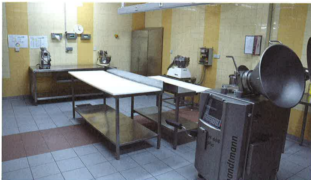
Salle « bleue » de la halle agroalimentaire, où l'on peut, sous basse température, hacher, mélanger, embosser des préparations à base de viande. Une salle « rouge » pour la cuisson, l'étuvage et le séchage des produits, et une salle « blanche » pour leur stérilisation complètent le dispositif de transformation.
